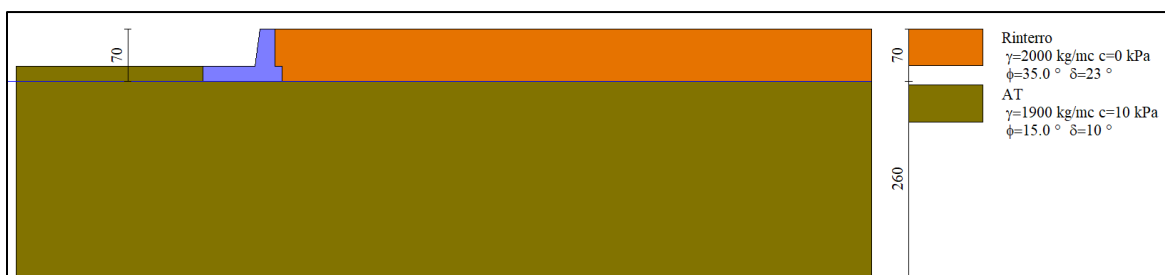
Figura 10-27: Muro di sostegno M1 – Schema fisico di riferimento
