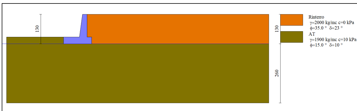
Figura 10-29: Muro di sostegno M2 – Schema fisico di riferimento
