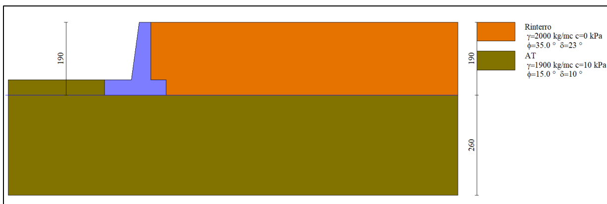
Figura 10-31: Muro di sostegno M3 – Schema fisico di riferimento
