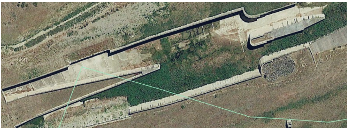
Figura 12.6: Vasca di dissipazione – Situazione dopo i primi crolli del 2013
