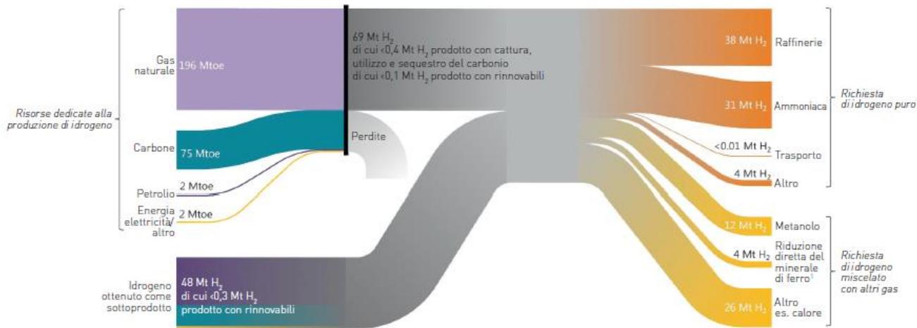
Figura 1 – Produzione ed usi finali dell'idrogeno (fonte: IEA)<sup>5</sup>
