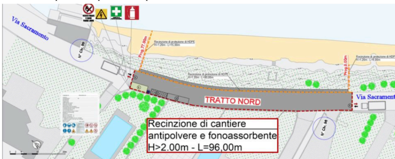
Figura 23 - Dettaglio aree di cantiere TRATTO NORD - evidenza limiti recinzione fonoassorbente/antipolvere
