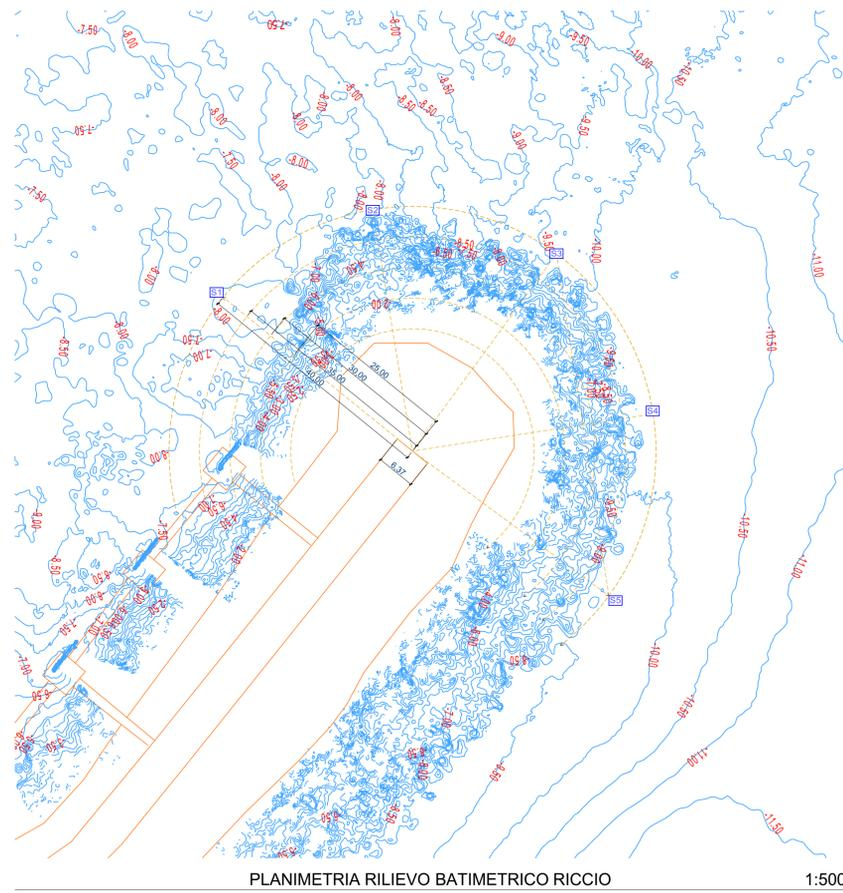
PLANIMETRIA RILIEVO BATIMETRICO RICCIO 1:500
