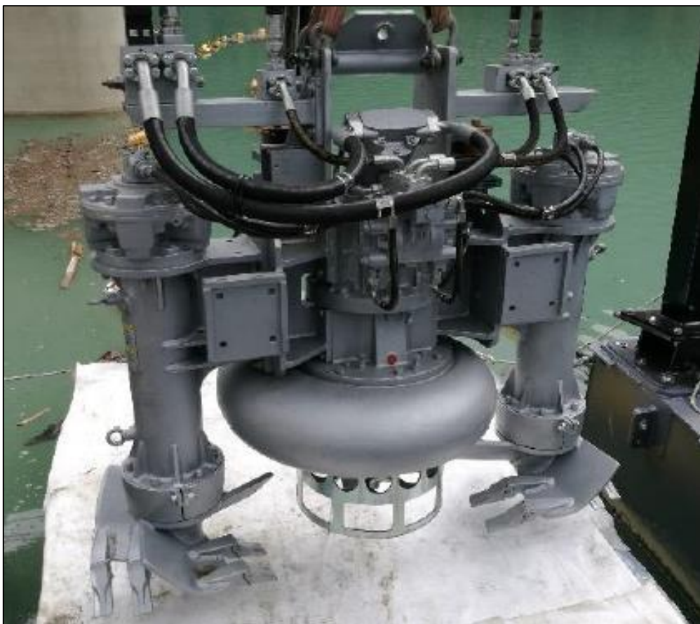
Figura 7-3: esempio di pompa idraulica sommergibile
