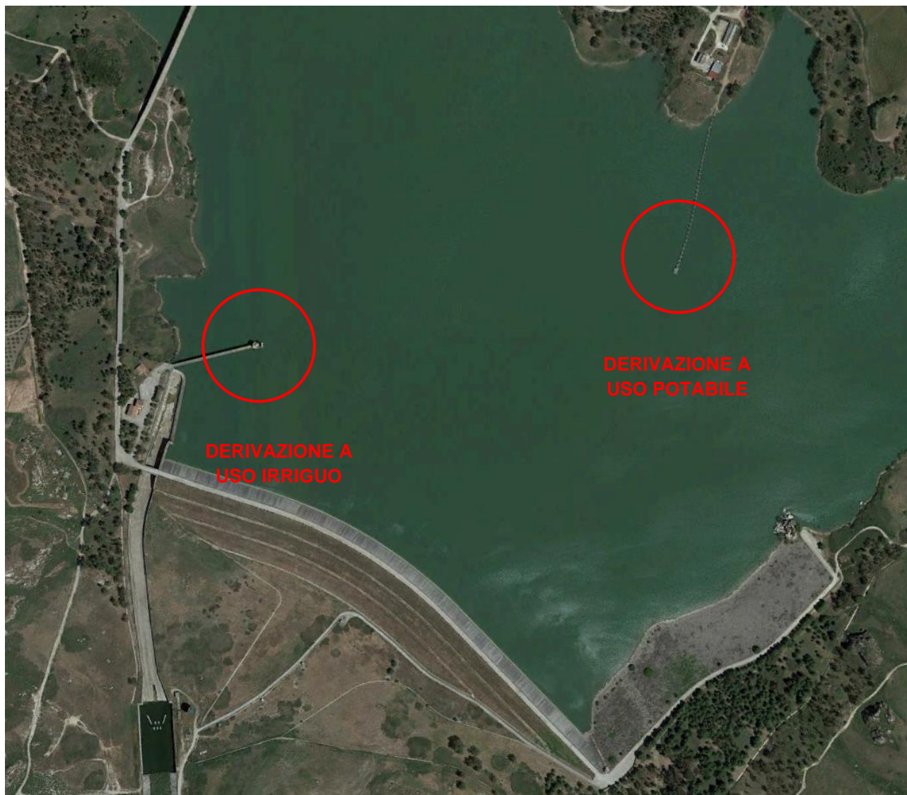
Figura 4-6: inquadramento planimetrico delle derivazioni a uso irriguo e potabile
