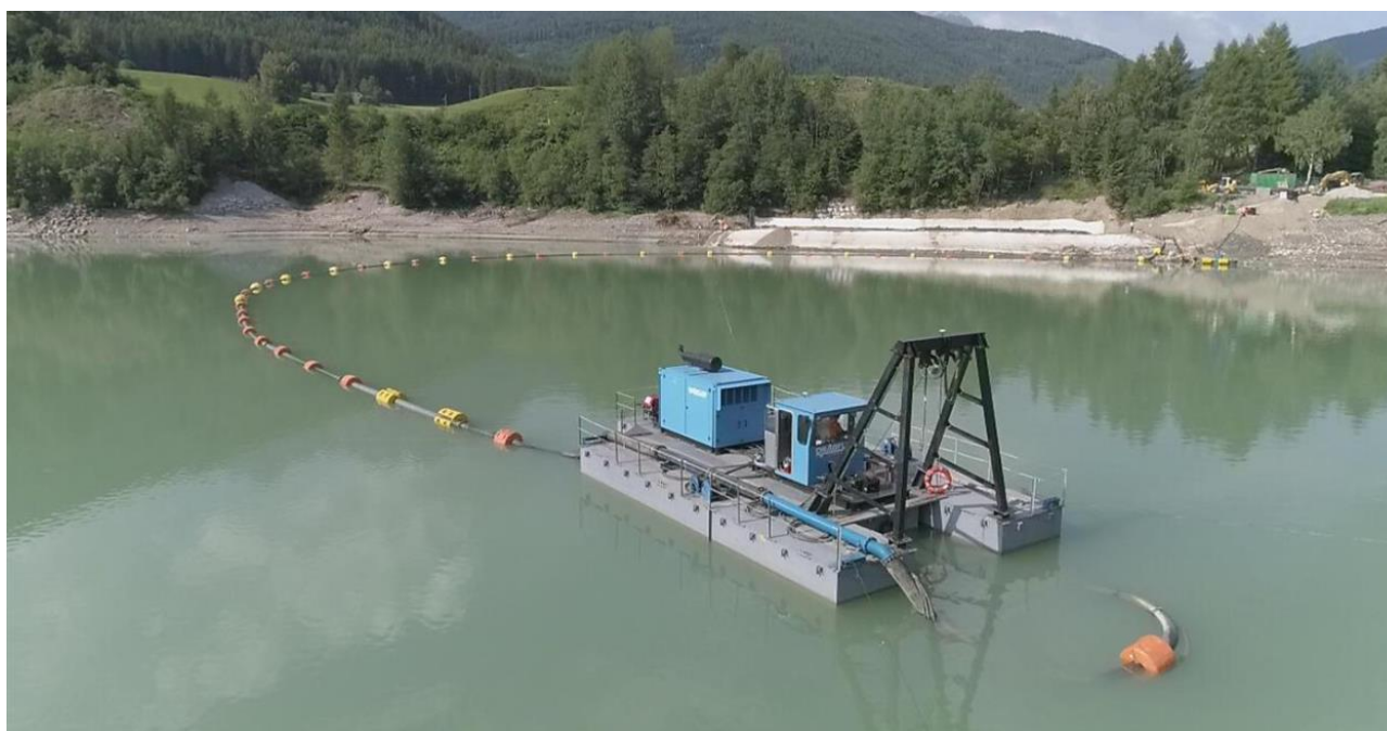
Figura 7-7: tubazione di pompaggio connessa al sistema pompante e all'area di stoccaggio
