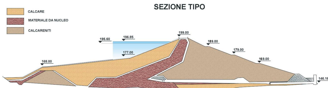
Figura 5-6: sezione trasversale tipo della diga di Poma
