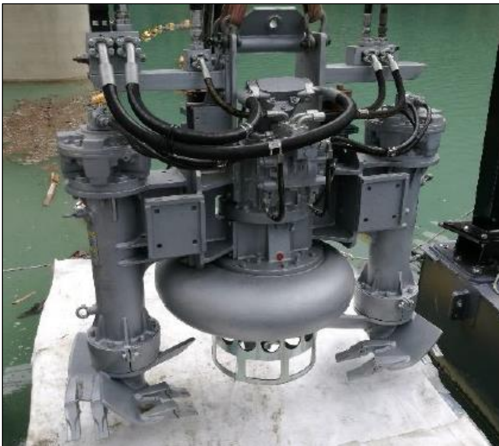
Figura 7-3: esempio di pompa idraulica sommersibile
