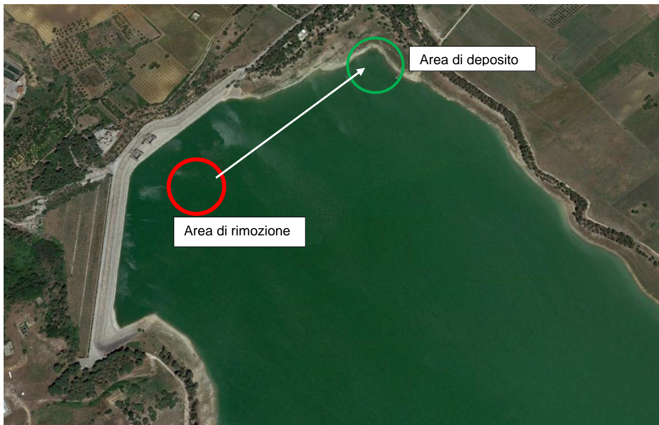
Figura 7-8: area di rimozione e area di stoccaggio del sedimento rimosso dall'invaso di Poma
