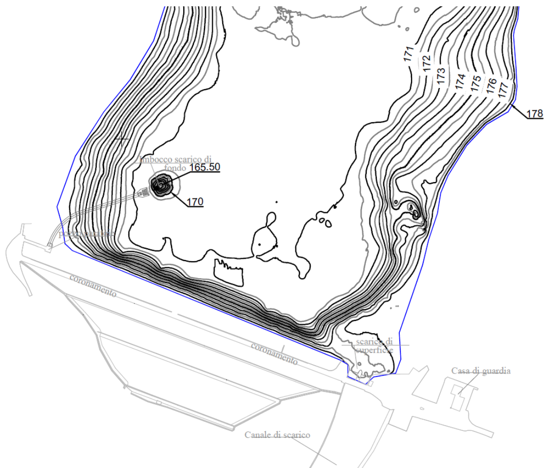
Figura 6-3: carta batimetrica isobate a 0,5 m (rilievo 2021) – dettaglio diga
