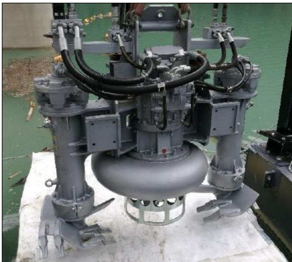
Figura 7-3: esempio di pompa idraulica sommergibile
