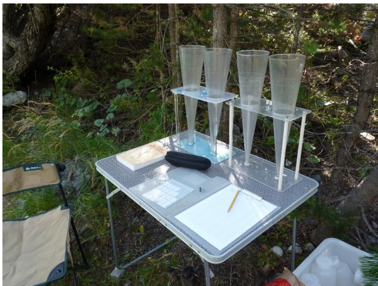
Figura 14-7: postazione per la misurazione dei solidi sedimentabili
