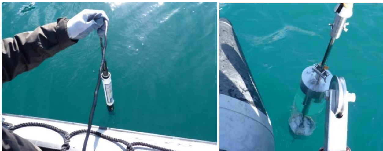
Figura 14-4: sonda multiparametrica e bottiglia a strappo di tipo Ruttner utilizzata per la caratterizzazione delle colonne d'acqua e la raccolta dei campioni a differenti profondità
