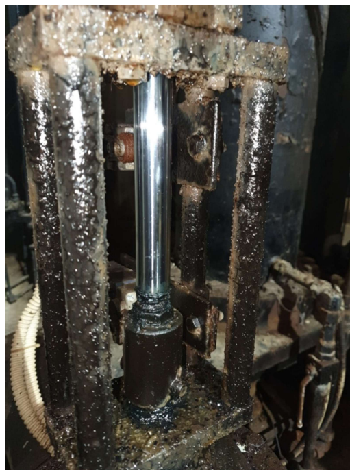
Figura 9 - Valvole con attuazione oleodinamica
