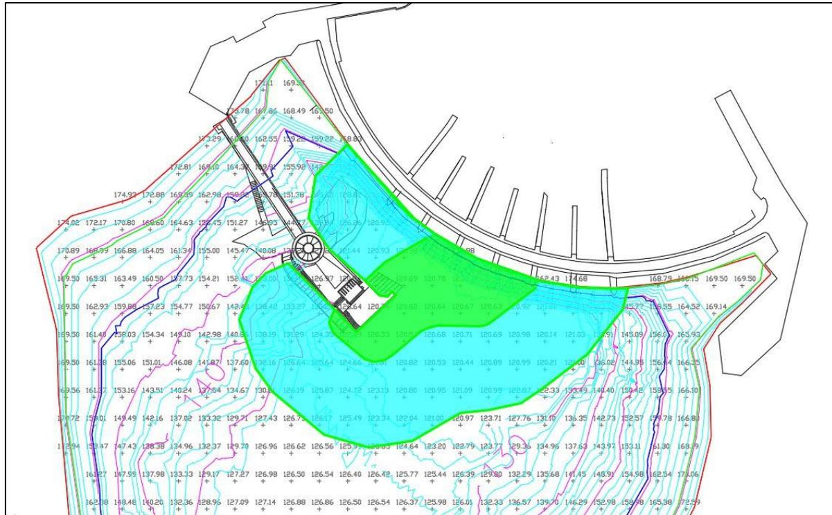
**Figura 1: Stralcio del rilievo batimetrico con localizzazione dell'area di intervento. In verde le zone in cui è previsto il raggiungimento della quota di 112 m slm. In azzurro le aree interessate dagli sbancamenti finalizzati al raggiungimento della quota obiettivo.**
