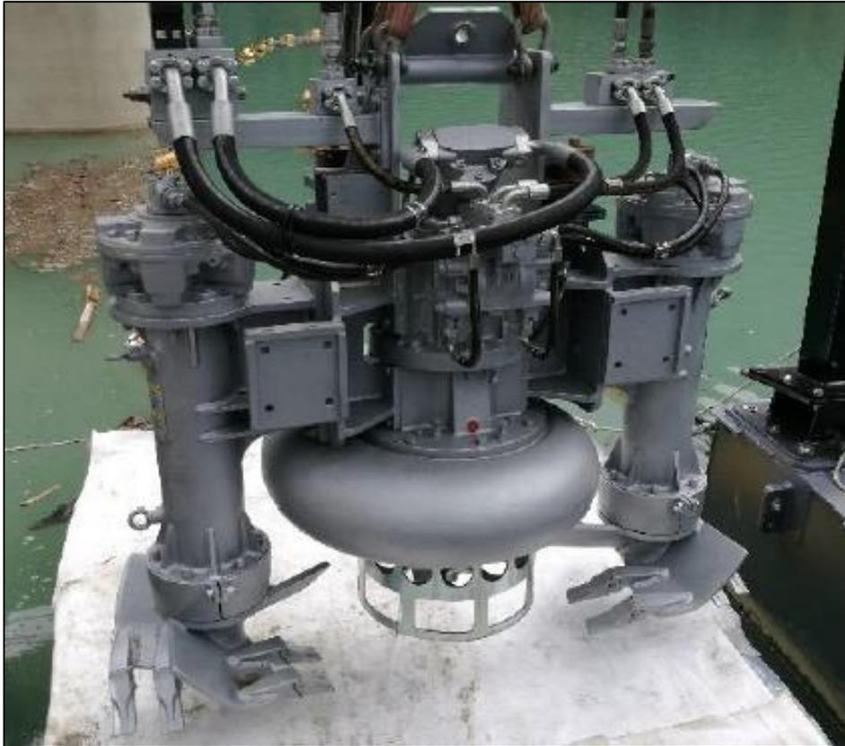
**Figura 7-3: esempio di pompa idraulica sommergibile**
