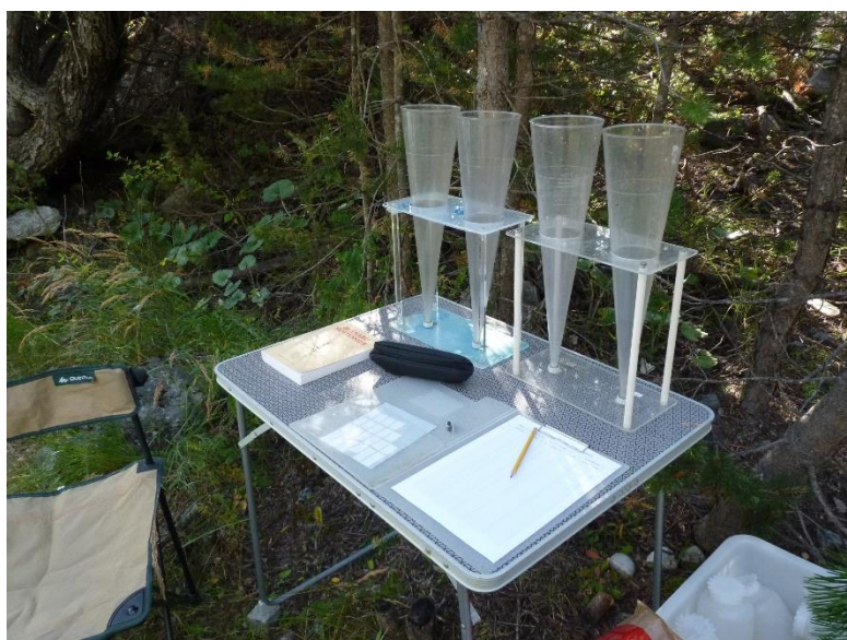
Figura 14-7: postazione per la misurazione dei solidi sedimentabili
