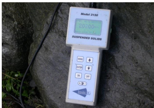
Figura 14-5: esempio di sonda portatile per la misurazione dei solidi sospesi
