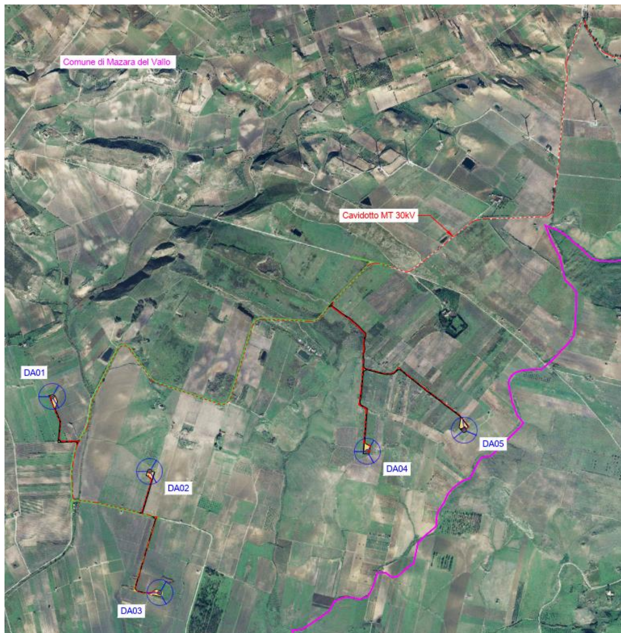
Figura 3-1 – Inquadramento generale da ortofoto – impianto eolico
