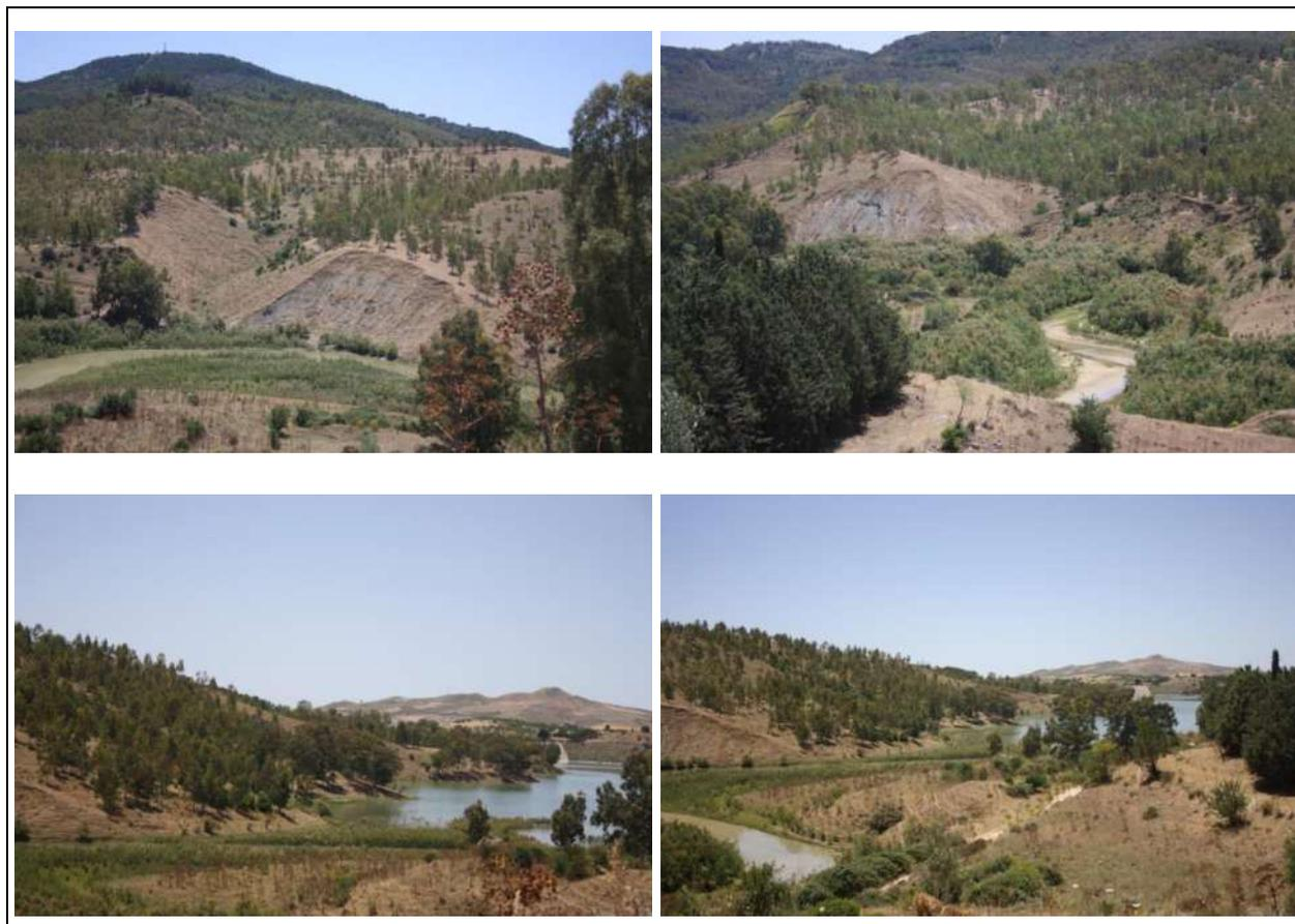
Fig. 2.3.5 – Immagini di frane e dissesti superficiali cartografati lungo la sponda sinistra del T. Olivo e della Diga Olivo.
