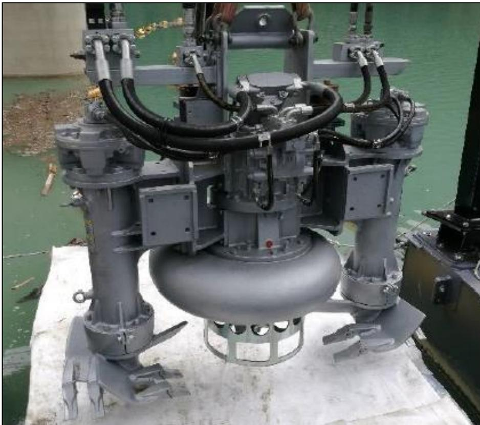
**Figura 7-3: esempio di pompa idraulica sommergibile**
