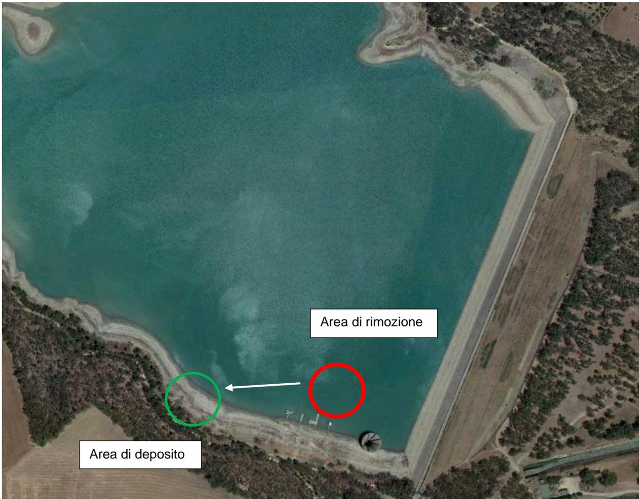
**Figura 7-7: area di rimozione e area di stoccaggio del sedimento rimosso dall'invaso di Nicoletti**
