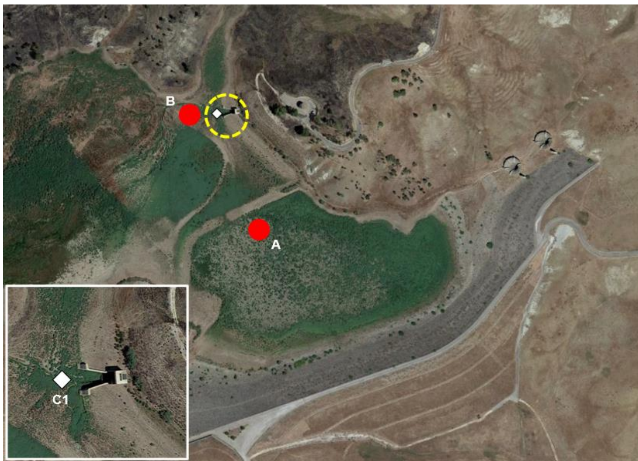
Figura 6-6: localizzazione punti di campionamento per l'analisi dei sedimenti del bacino Gibbesi i cerchi rossi indicano i punti di campionamento superficiale, in giallo l'area oggetto di carotaggio (di cui è riportato un ingrandimento), il rombo bianco indica il punto di carotaggio per la caratterizzazione del sedimento presso lo scarico di fondo
