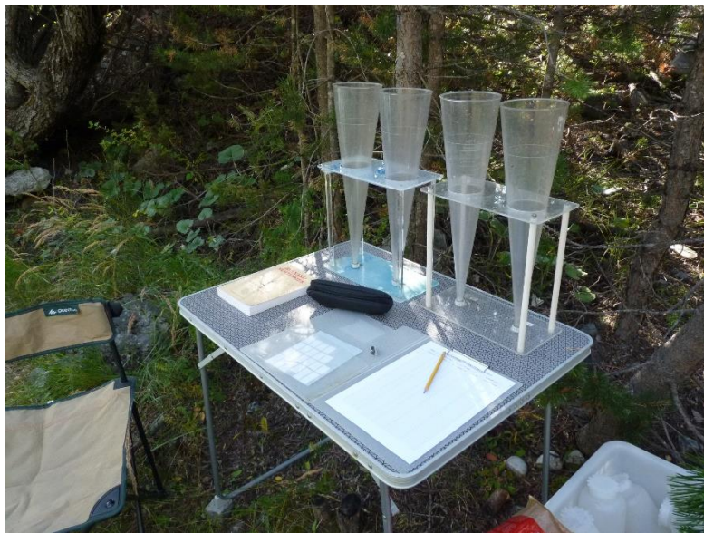
Figura 13-5: postazione per la misurazione dei solidi sedimentabili
