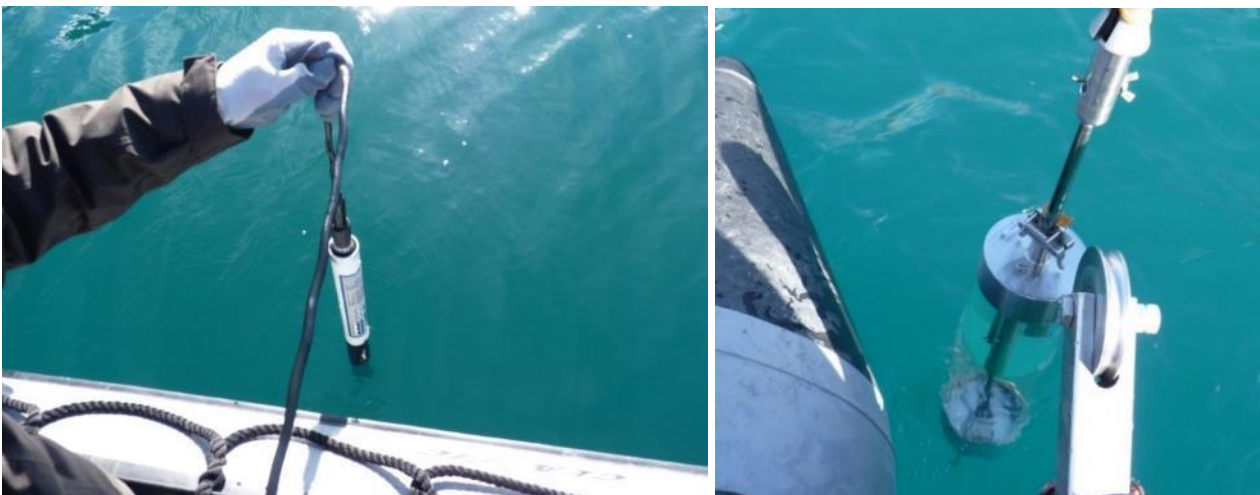
Figura 14-4: sonda multiparametrica e bottiglia a strappo di tipo Ruttner utilizzata per la caratterizzazione delle colonne d'acqua e la raccolta dei campioni a differenti profondità
