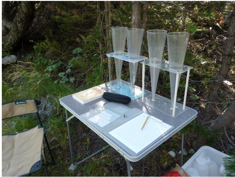
Figura 14-7: postazione per la misurazione dei solidi sedimentabili
