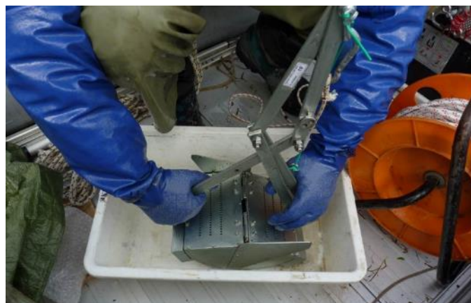
Figura 14-2: benna tipo Ponar utilizzata per il prelievo dei sedimenti
