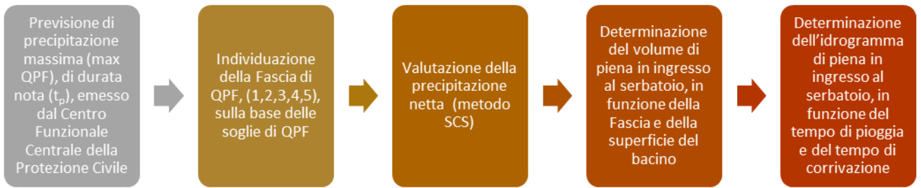
Figura 16 - Schema del modello idrologico adottato (tp=3, 6, 12, 18, 24 ore).
