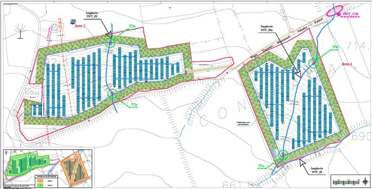
CONSIDERATO che relativamente al *cavidotto di connessione* dell'impianto alla cabina di consegna, si individua un'unica interferenza tra lo stesso impluvio dell'area progettuale 1 e la Reggia Trazzera Mussomeli-Villalba-Polizzi lungo la quale si snoderà il cavidotto di connessione che verrà risolto attraverso un passaggio in sub-alveo con metodologia TOC (Trivellazione Orizzontale Controllata);
