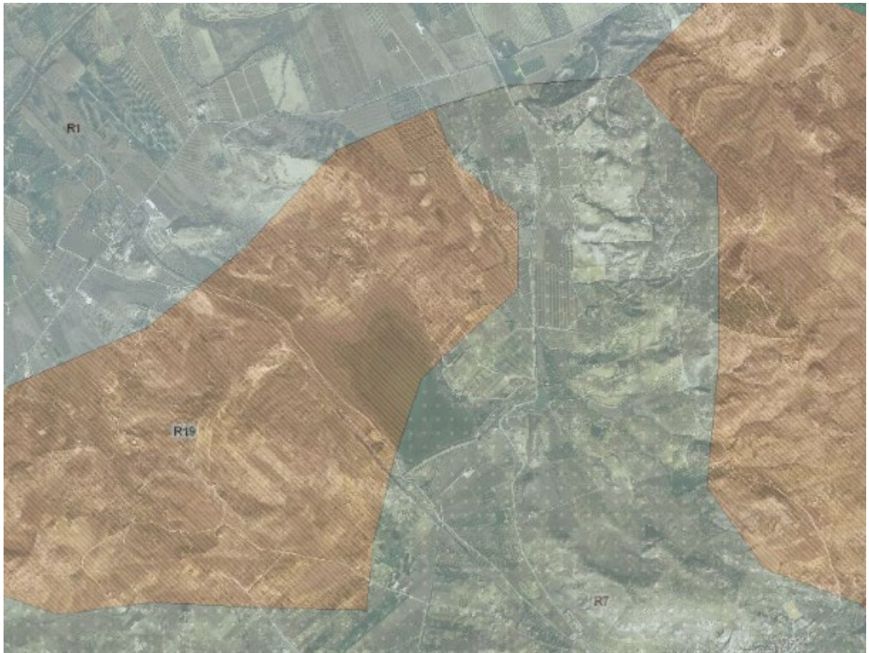
FIGURA 4-11 CARTA GEOLOGICA NELL'AREA DI INVASO (FONTE: GEOPORTALE NAZIONALE). R1= DETRITI, DEPOSITI ALLUVIONALI E FLUVIOLACUSTRI, SPIAGGE ATTUALI (OLOCENE); R7 = SABBIE E CONGLOMERATI (PLEISTOCENE); R19 = FORMAZIONE GESSOSO-SOLFIFERA (MIOCENE SUPERIORE).
