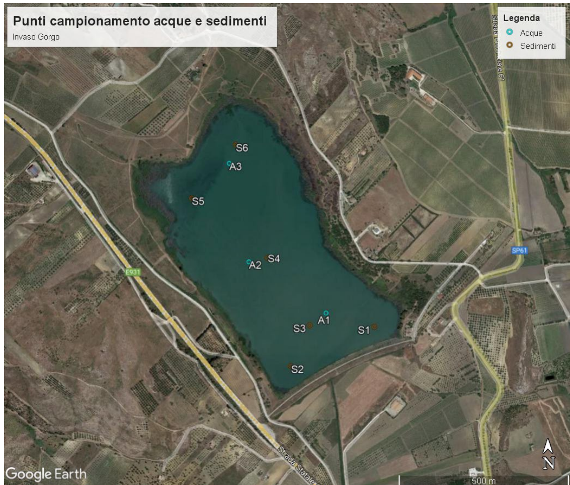
FIGURA 4-19 UBICAZIONE PRELIMINARE DEI PUNTI DI CAMPIONAMENTO PER LA CARATTERIZZAZIONE DEI SEDIMENTI (PUNTI S) E PER LA CARATTERIZZAZIONE DELLE ACQUE (PUNTI A)
