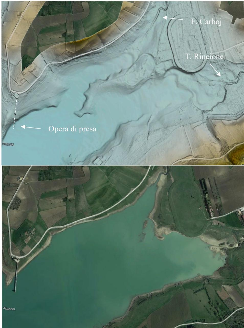
FIGURA 4-16 – RILIEVO TOPO-BATIMETRICO DELL'INVASO ARANCIO AL PUNTO DI IMMISSIONE DEL FIUME CARBOJ E DEL TORRENTE RINCIONE.
