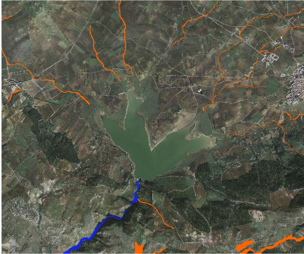
FIGURA 4-1 PAI PERICOLOSITÀ IDROGEOLOGICA NELL'AREA DI INVASO. BLU A VALLE = PERICOLO ALLUVIONE ELEVATO, ARANCIONE = PERICOLO FRANA MEDIO (FONTE: GEOPORTALE NAZIONALE)
