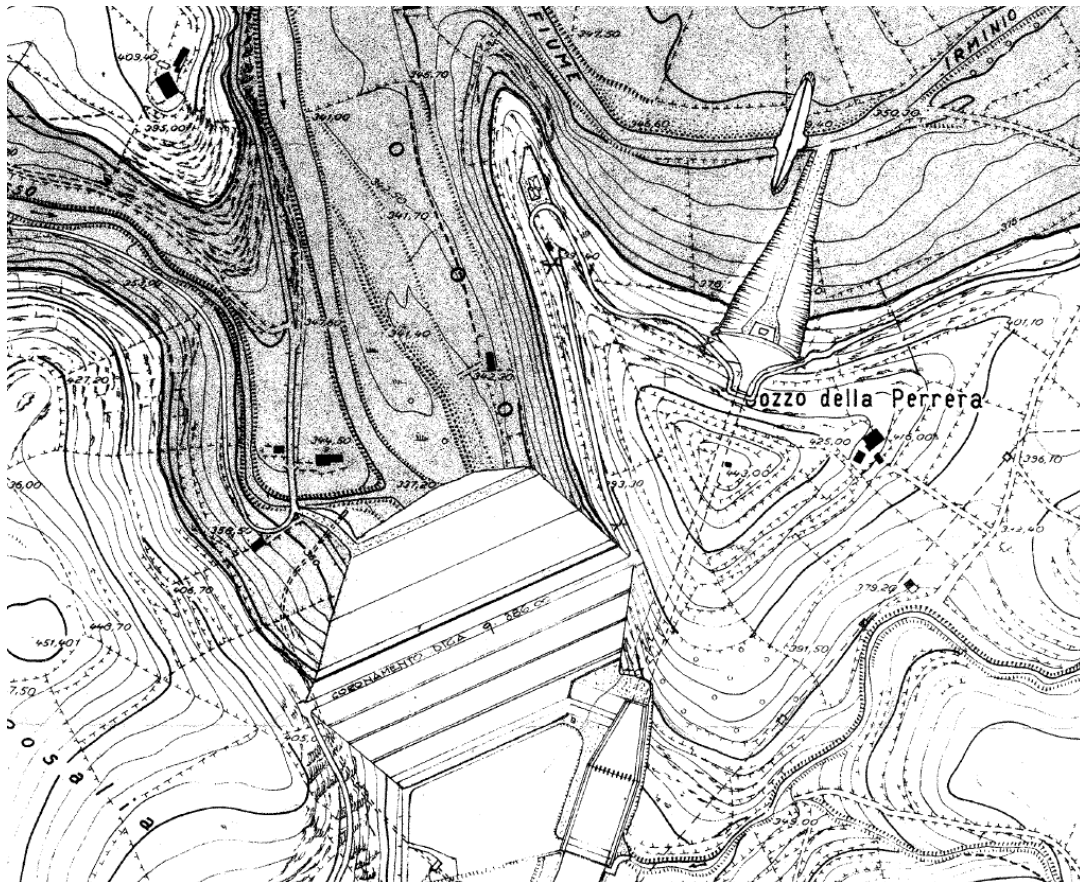
Figura 3-2: planimetria di progetto della diga di Santa Rosalia e delle opere di scarico (atti di collaudo 1983)
