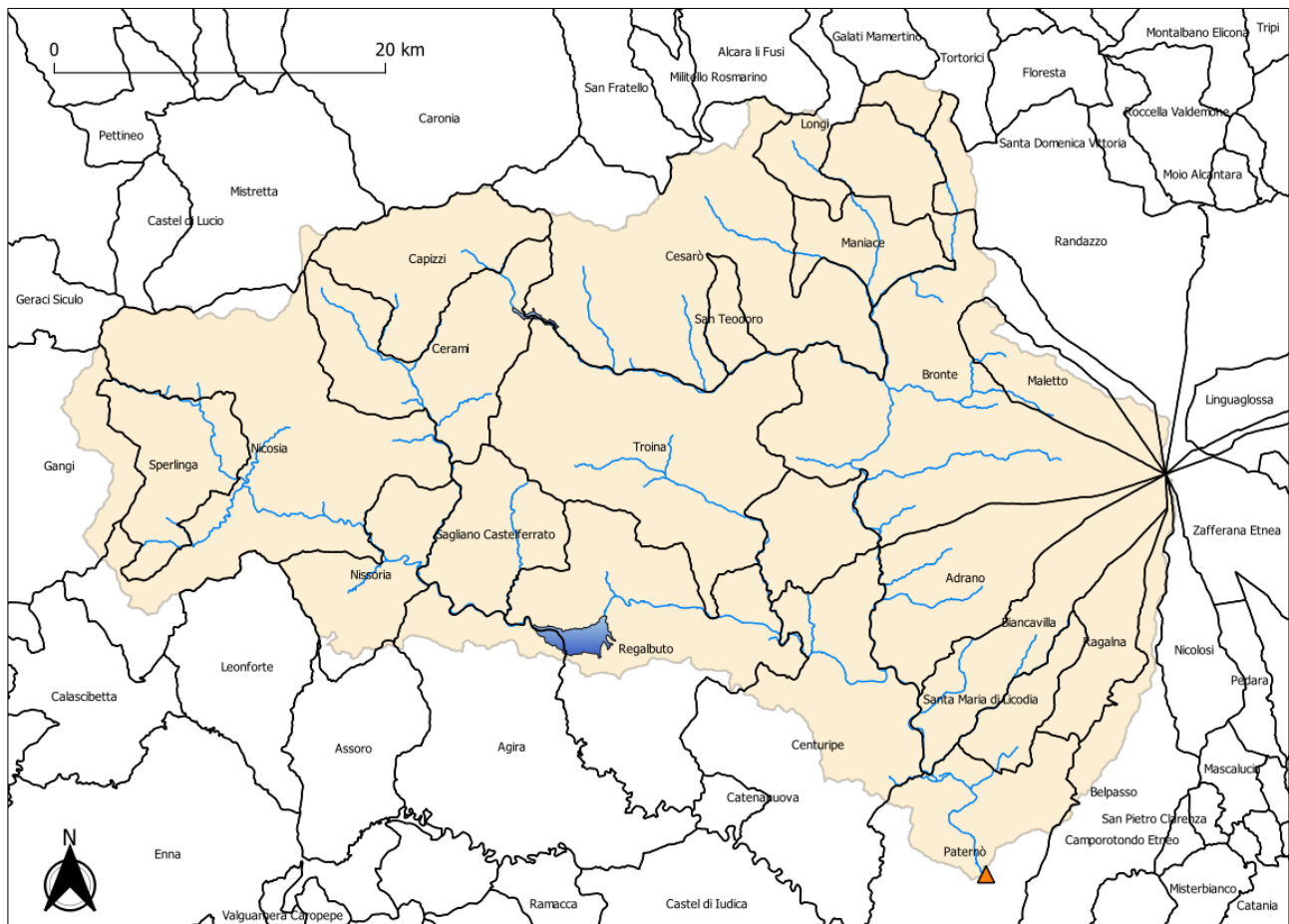
Figura 3-20: limiti amministrativi comunali all'interno del bacino allacciato all'invaso di Lentini, con sezione di chiusura posta in corrispondenza della traversa fluviale di Ponte Barca (rappresentata dall'icona triangolare arancione)
