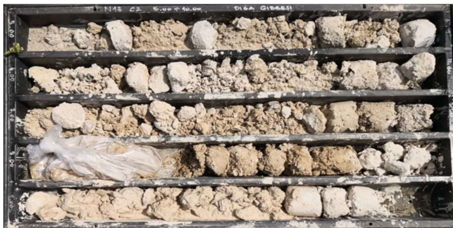
Figura 5-8 Cassetta catalogatrice numero 2 della perforazione di sondaggio N13DH (5.0-10.0m) contenente materiale del contronucleo.
