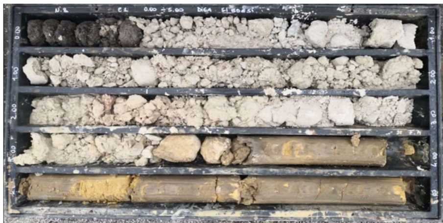
Figura 5-6 Cassetta catalogatrice numero 1 della perforazione di sondaggio N8 (0.0-5.0m) contenente carote del sottofondo stradale e del nucleo della diga.
