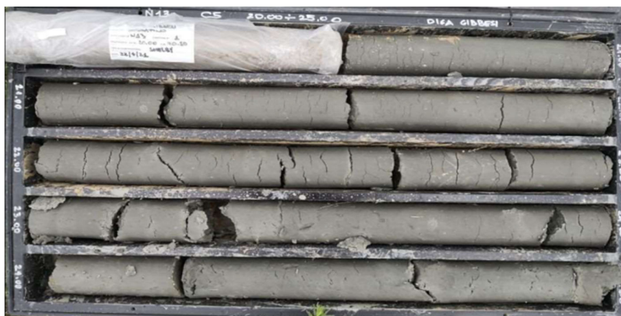
Figura 5-9 Cassetta catalogatrice numero 5 della perforazione di sondaggio N13DH (20.0-25.0m) contenente carote della formazione delle argille puddingoidi di base.
