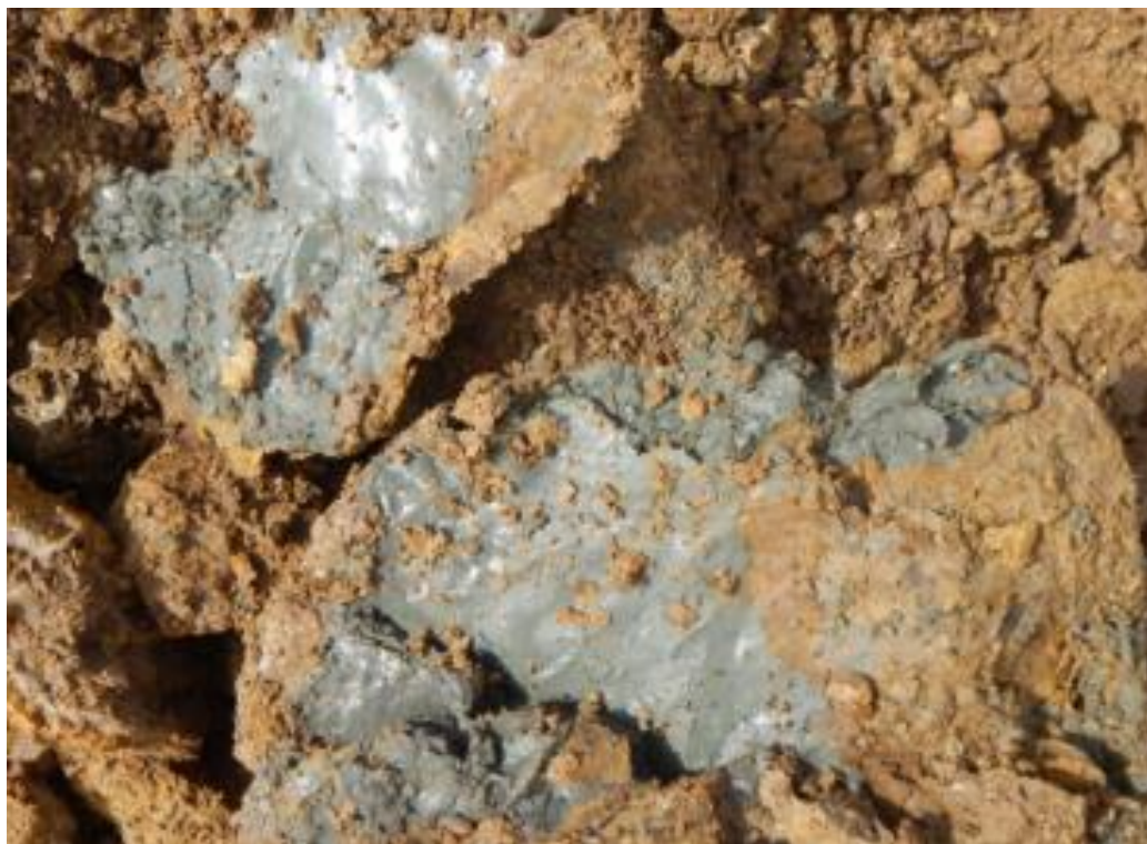
Fig. 4-2 Area 3 – Pozzetto TP11 (3 m). Argille AT. Superfici concoidi, lucide e striate
