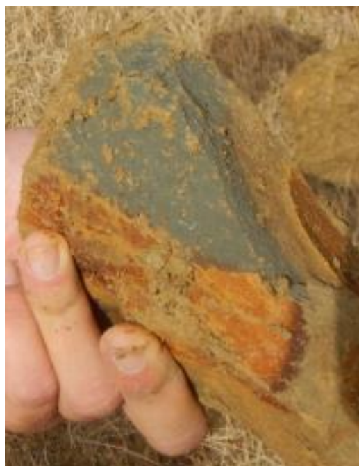
Fig. 4-3 Area 3 – Pozzetto TP12 (2,6 m). Argilla ATa. Elementi marnosa di forma prismatica allungata
