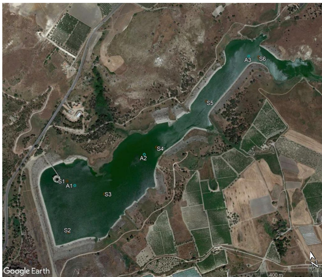
FIGURA 4-20 UBICAZIONE DEI PUNTI DI CAMPIONAMENTO PER LA CARATTERIZZAZIONE DEI SEDIMENTI (PUNTI S) E PER LA CARATTERIZZAZIONE DELLE ACQUE (PUNTI A)
