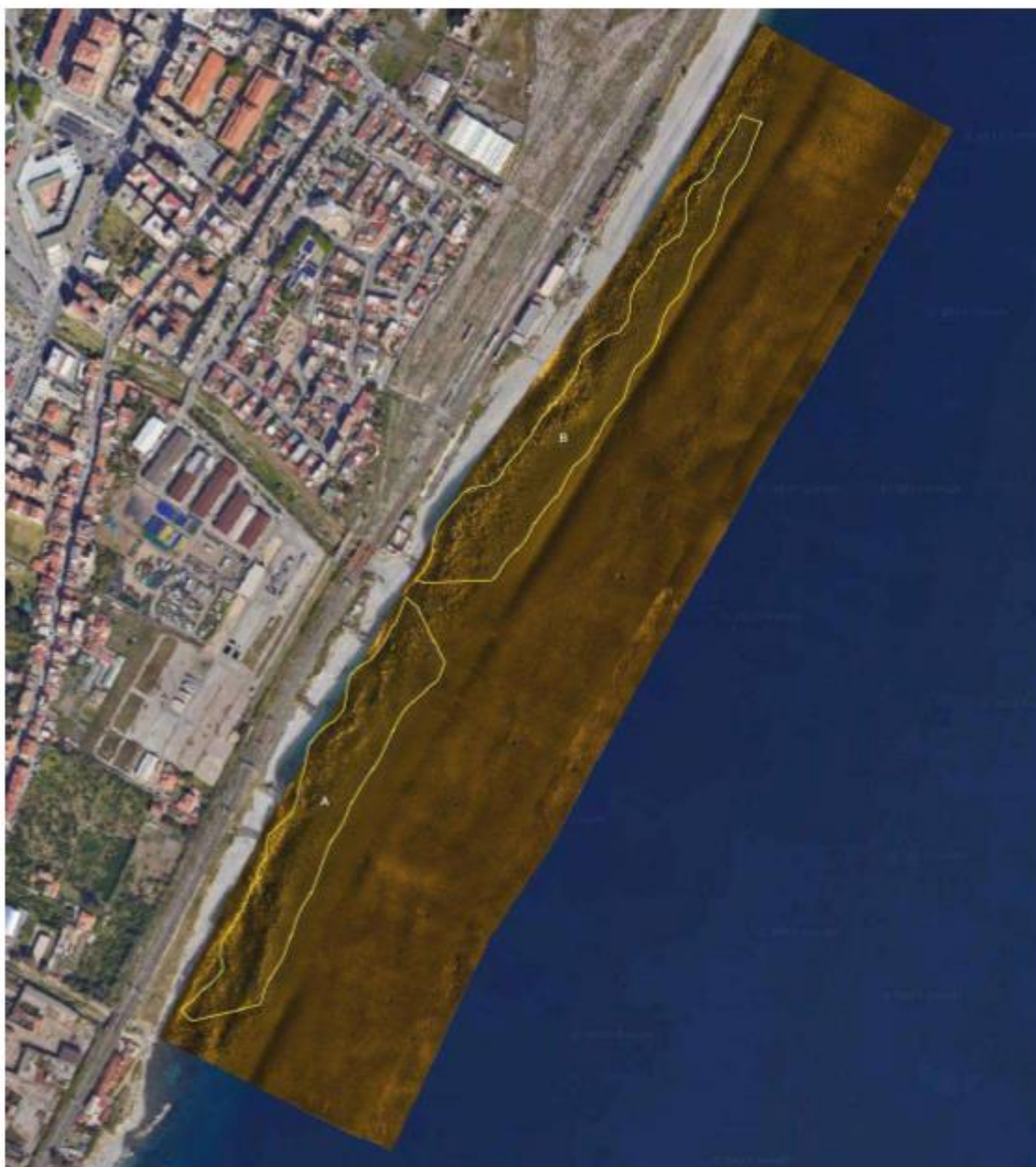
Figura 14 - Sovrapposizione rilievo S.S.S. con ortofoto e posizione aree di deposito
