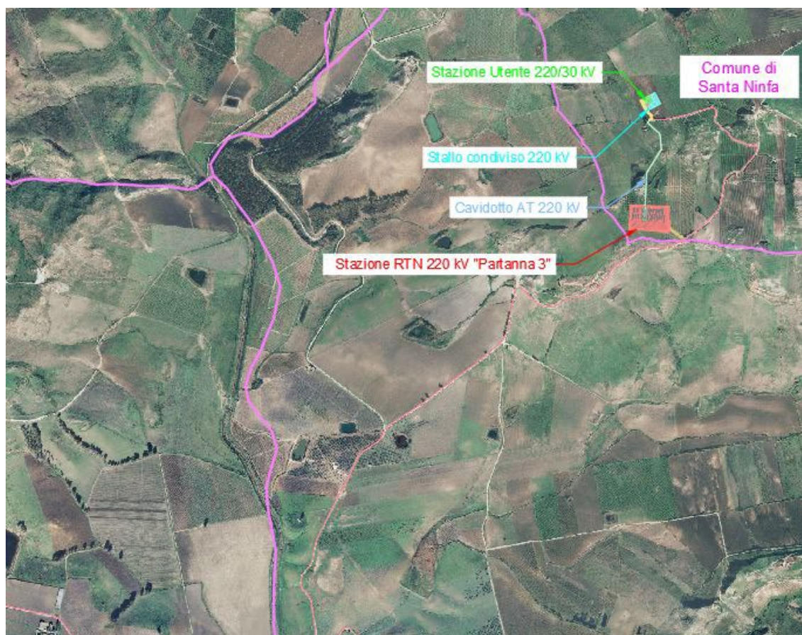
Figura 3.2 Inquadramento generale da ortofoto – opere di connessione
