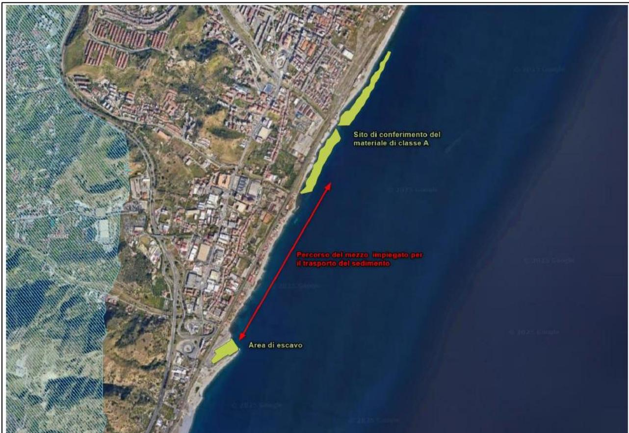
Figura 1 Rotta del mezzo dedicato alle operazioni di trasporto del sedimento
