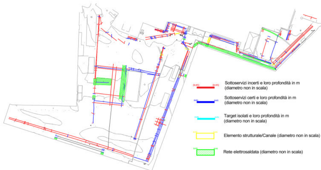
Figura 26: Esiti indagine georadar
