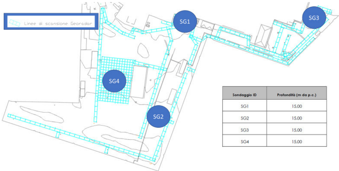
Figura 14: Sondaggi geognostici eseguiti a carotaggio continuo
