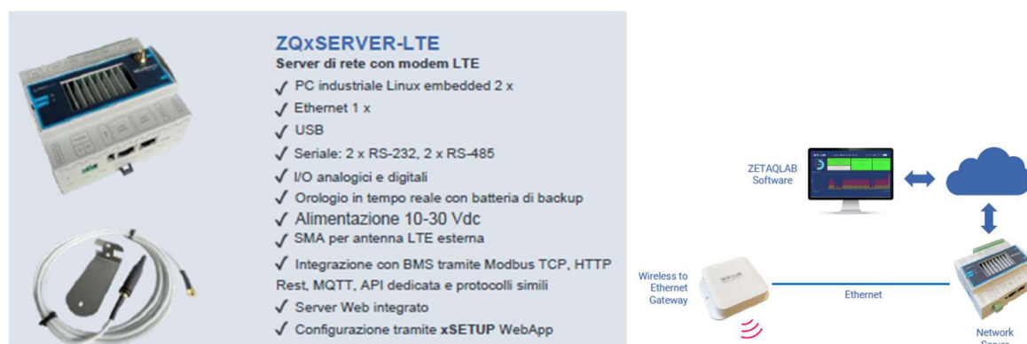
Figura 27: Schema connessione tra gateway e server di gestione
