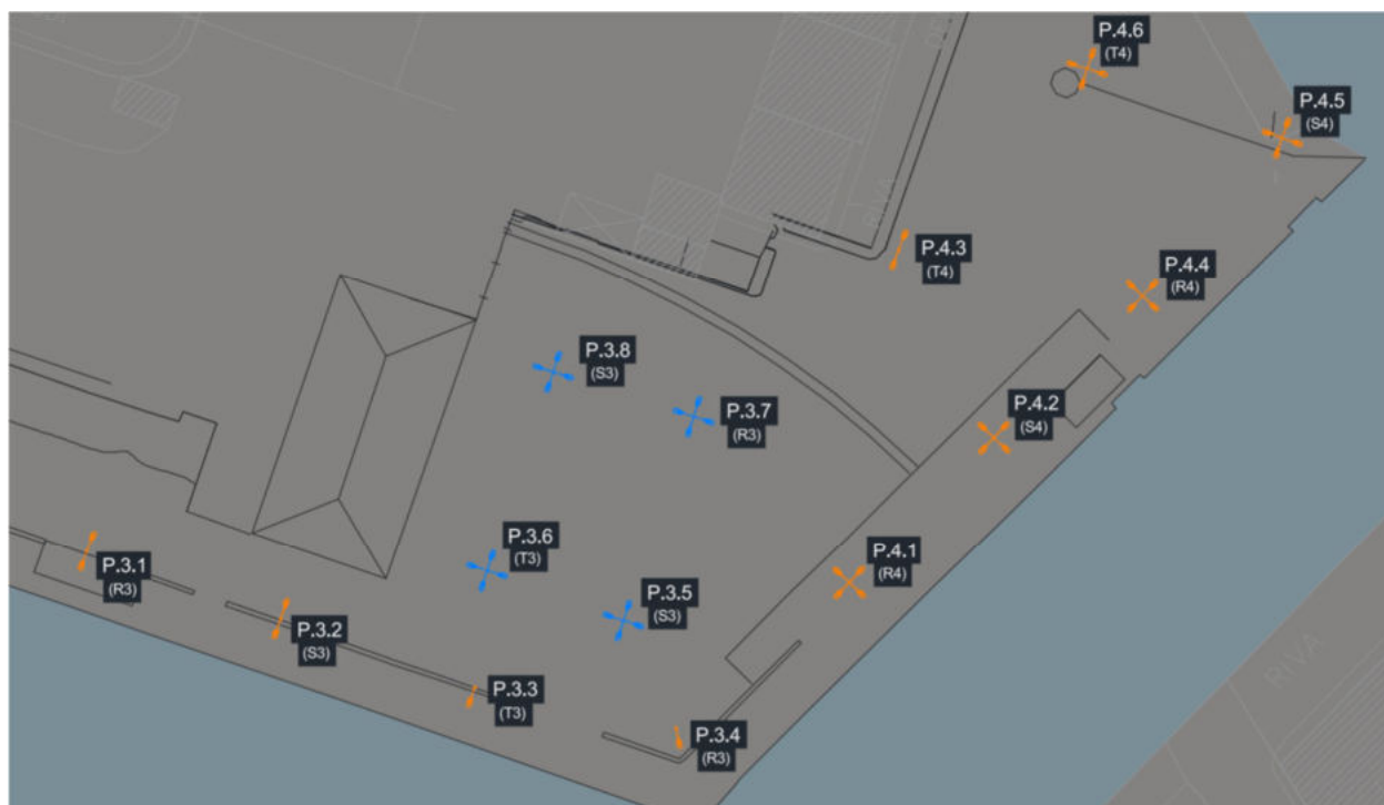
Figura 10 Disposizione pali per l'illuminazione di progetto dei parcheggi di Piazza Quattro Novembre,
