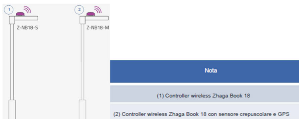
Figura 21 sistema di comunicazione fra i nodi wireless applicati ai connettori zhaga delle armature su palo
