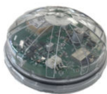
Figura 22 nodo wireless z-nb18 di comunicazione connesso al driver dell’apparecchio led tramite la connessione facilitata zhaga
