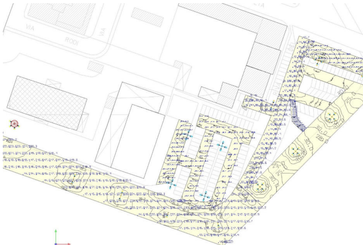
Figura 12 Rappresentazione delle griglie di calcolo con la valutazione dei parametri illuminotecnici con suddivisione in 9superfici di calcolo distinte.
