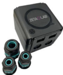
Figura 24 Nodo wireless Z-CUBE di comunicazione per la connessione ai driver dei proiettori Led o in generale a gruppi di apparecchi di illuminazione predisposti per il telecontrollo
