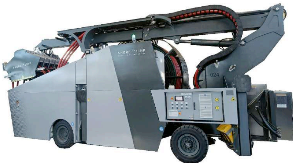
Figura 19: Sistema CMS Shorelink con braccio chiuso
