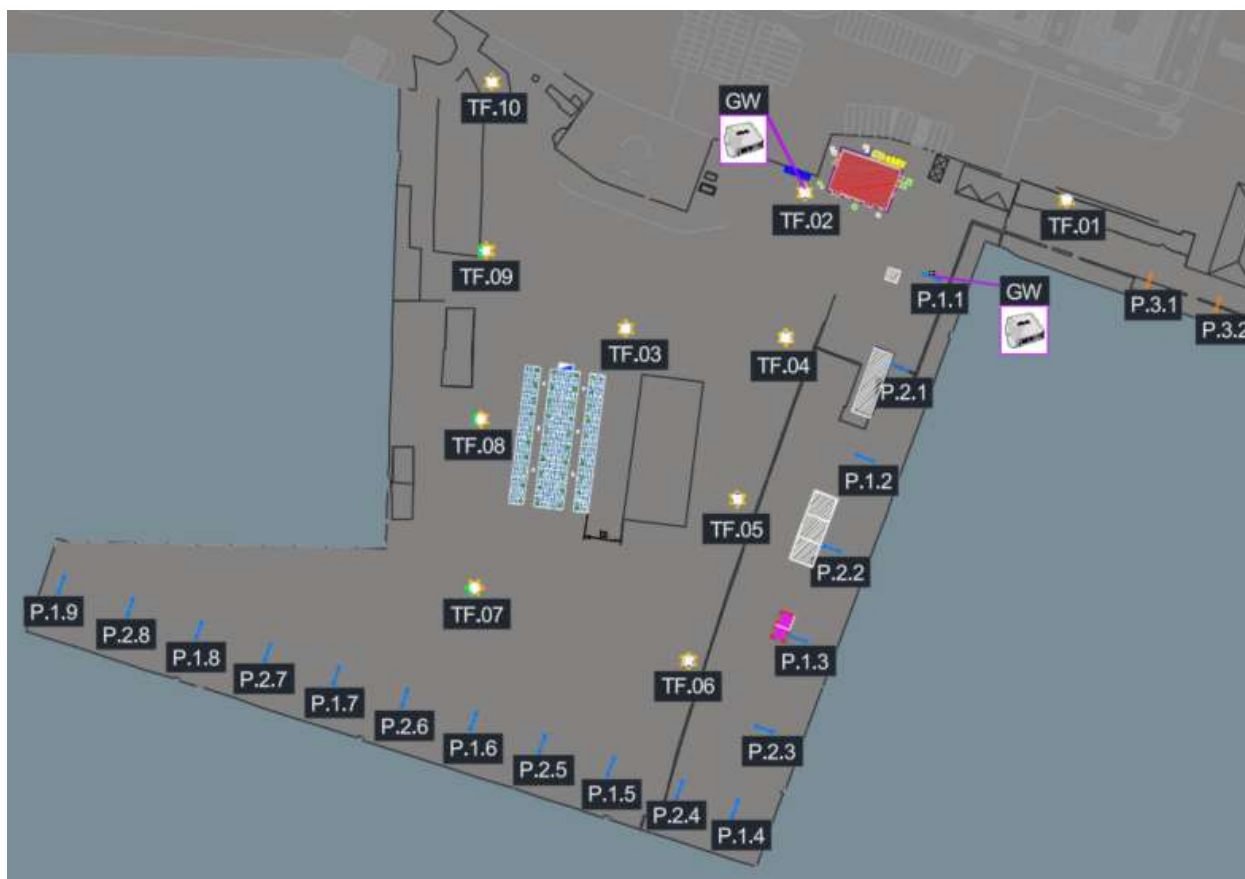
Figura 32: Planimetria distribuzione impianto illuminazione generale esterna Molo.
