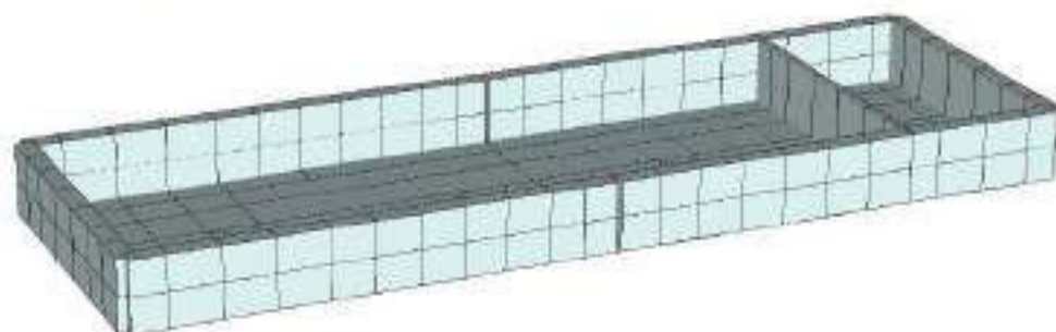
modello strutturale VASCA di FONDAZIONE (373+373) x 242 (box BDM2_70p mod.750)
