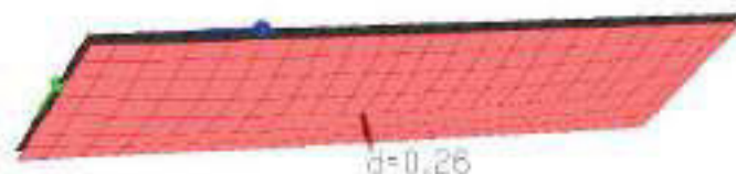
Deformazione SOLETTA di COPERTURA CABINA in SLD/SLE
