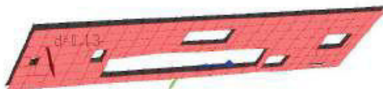
Deformazione SOLETTA di CALPESTIO CABINA in SLD/SLE
