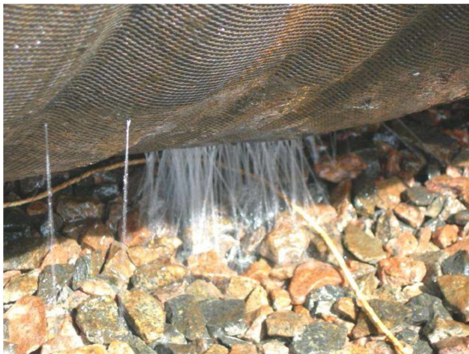
FIGURA 4-3 PARTICOLARE DELLA TRAMA DRENANTE DEL GEOTUBO
