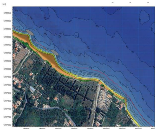
Figura 9-7 Stato di progetto - Risultati del modello morfologico dopo 2 anni di simulazione per il tratto di litorale ubicato più a Sud. In rosso ed in bianco sono riportate rispettivamente le batimetriche di -2 m e 0 m relativamente allo stato iniziale della simulazione.
