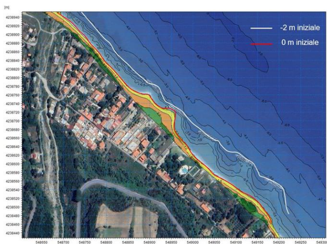
Figura 9-5 Stato attuale - Risultati del modello morfologico dopo 1 anno di simulazione. In rosso ed in bianco sono riportate rispettivamente le batimetrie di -2m e 0m relativamente allo stato iniziale della simulazione.
