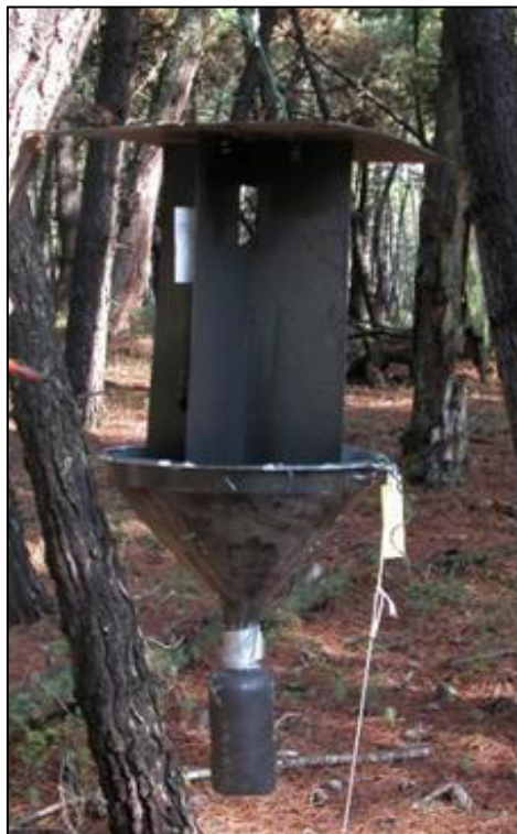
Figura 6. Trappola cross-vane. Foto Fabrizio Pennacchio CREA-DC.
