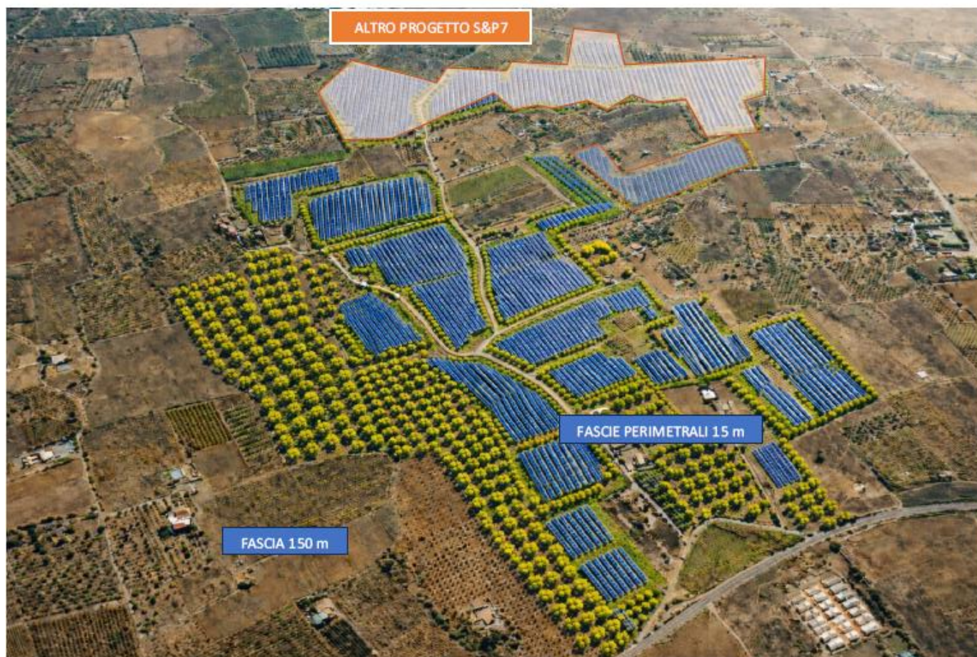
Fig. 1 – Vista aerea d’insieme del progetto S&P 17 utile a rappresentare le misure di mitigazione adottate (fasce perimetrali di 15 m) e il potenziale rapporto percettivo con gli impianti presenti nell’intorno.
