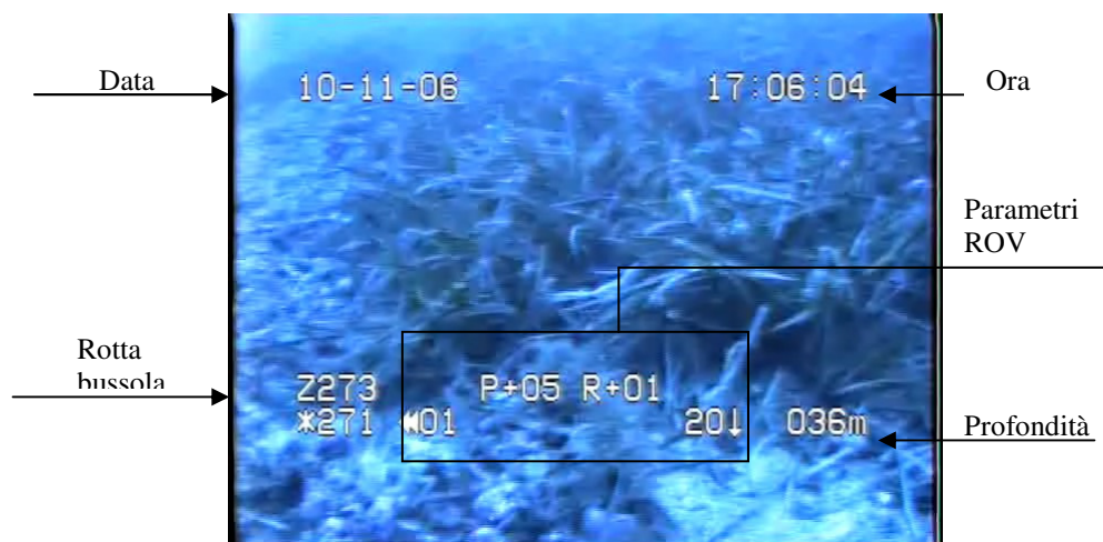
Figura 3.4.1.2 – Overlay dei parametri di navigazione del ROV
