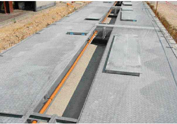
Versione zincata con botole longitudinali
